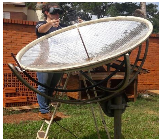
Figura 4. Concentrador solar con espejos como material reflectante.
