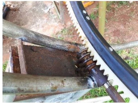
Figura 3. Tornillo sin fin, y arco con dientes, para el seguimiento solar.
