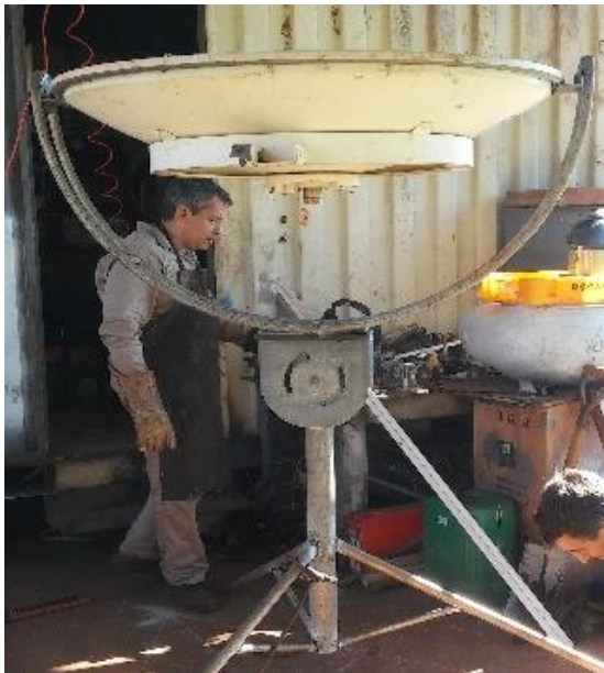
Figura 2. Concentrador solar parabólico con su soporte y sistema de seguimiento.
