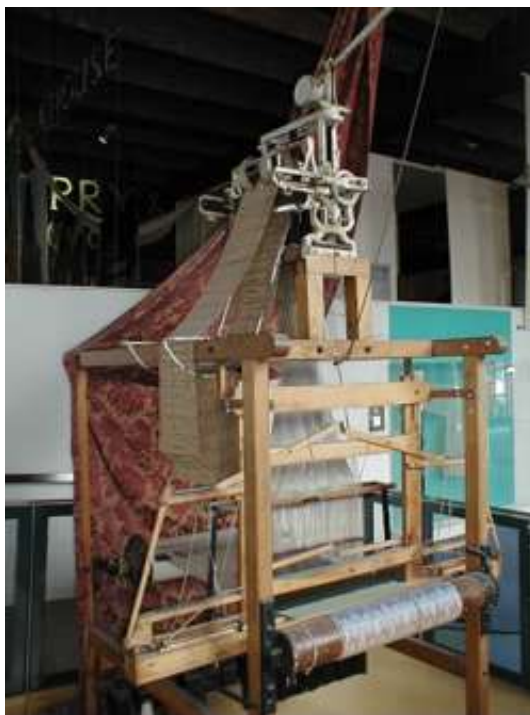
Imágenes 12 y 13: A la izquierda, un telar de Jacquard en el Museo de la Ciencia y la Industria de Manchester, junto al detalle de su sistema de tarjetas perforadas a la derecha. Fuente: George H. Williams [Wikipedia].
