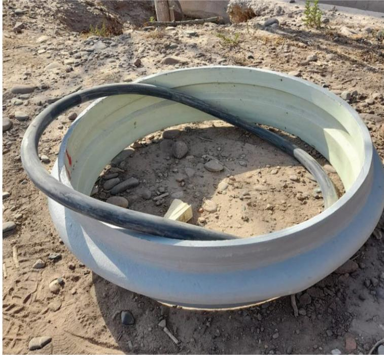
*Figura 20: Manguito de empotramiento para cañería de PRFV DN 700 mm. Exteriormente se observa el aro laminado que queda empotrado en el hormigón, mientras que interiormente se dispone un aro de goma que garantiza estanqueidad*
