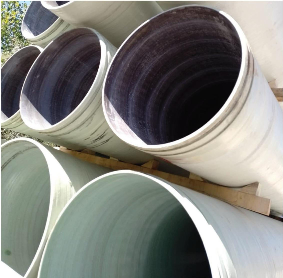
*Figura 4: Cañería de PRFV DN 700 mm con liner interior anti-abrasivo que se observa de color negruzco (superior) y de DN 800 mm con liner estándar (inferior)*
