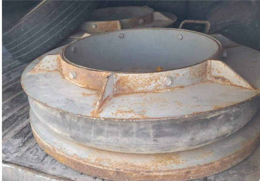
*Figura 17: Tapones empleados para las pruebas neumáticas de cañería*
