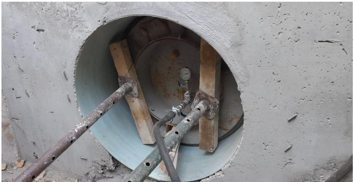
*Figura 18: Apuntalamiento de tapones en extremos del tramo de cañería a ensayar*
