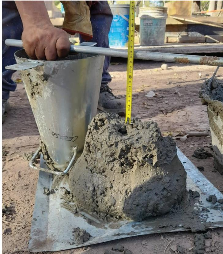
*Figura 48: Ensayo de asentamiento mediante método de cono de Abrams. En este caso se obtuvo un asentamiento de 13,5 cm previo a la incorporación de aditivos, por lo que se repitió el ensayo y, tras obtener un resultado semejante, se rechazó el camión hormigonero por la presunción de un contenido de agua mayor a lo deseado, con las afectaciones negativas que esto trae sobre el hormigón*
