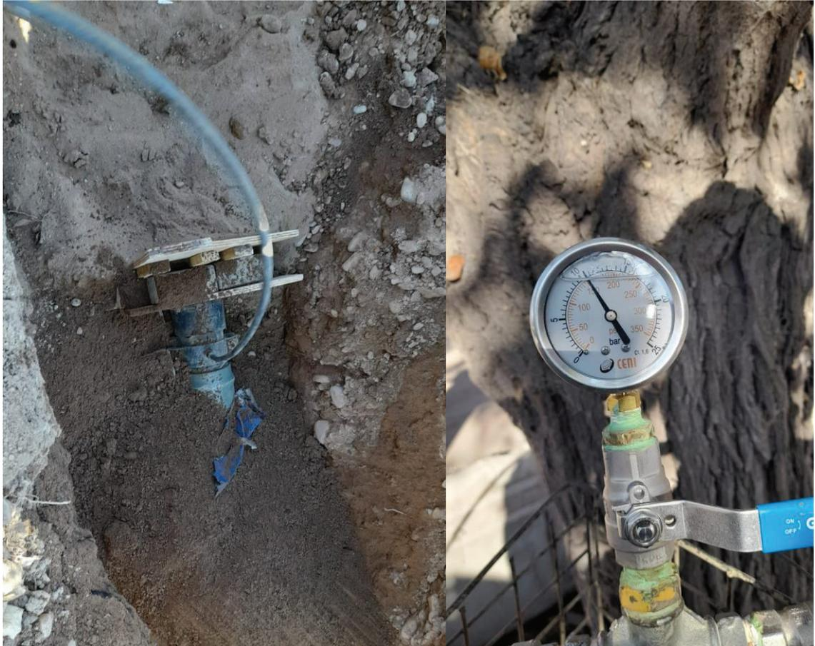
*Figura 67: Prueba hidráulica de cañería de agua de PVC JE K10. A la izquierda se observa el tapón de PVC de junta elástica, dispuesto en el extremo de la cañería instalada, para introducir la presión de prueba con agua. A la derecha, manómetro con lectura en ascenso durante el proceso de carga de la cañería*
