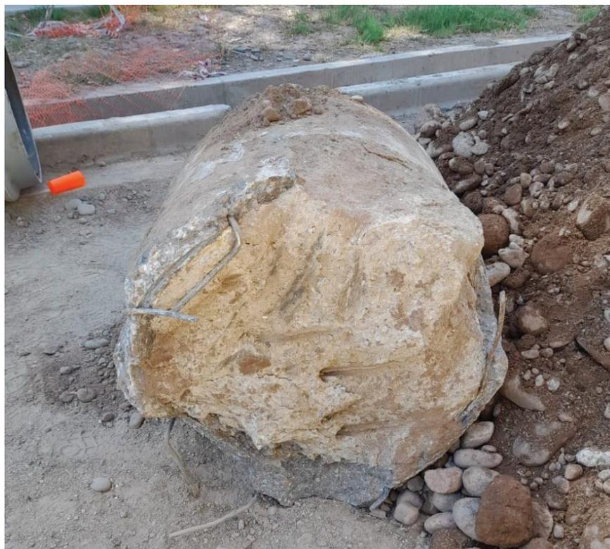
*Figura 65: Tramo de cañería extraído para evaluar el resultado final de la metodología de cegado. Se aprecia una sección completamente rellena con RDC, por lo que el método es satisfactorio*
