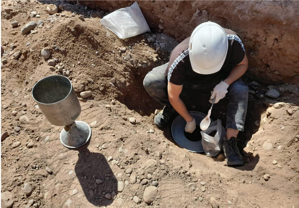
*Figura 45: Control de compactación mediante método del cono de arena. En ocasiones, cuando se tiene dudas respecto del espesor de la capa de relleno efectuada o de la eficiencia del método de compactación en profundidad, se exige descartar la capa superficial (donde apoya directamente el equipo de compactación) y efectuar el ensayo por debajo de dicho estrato*
