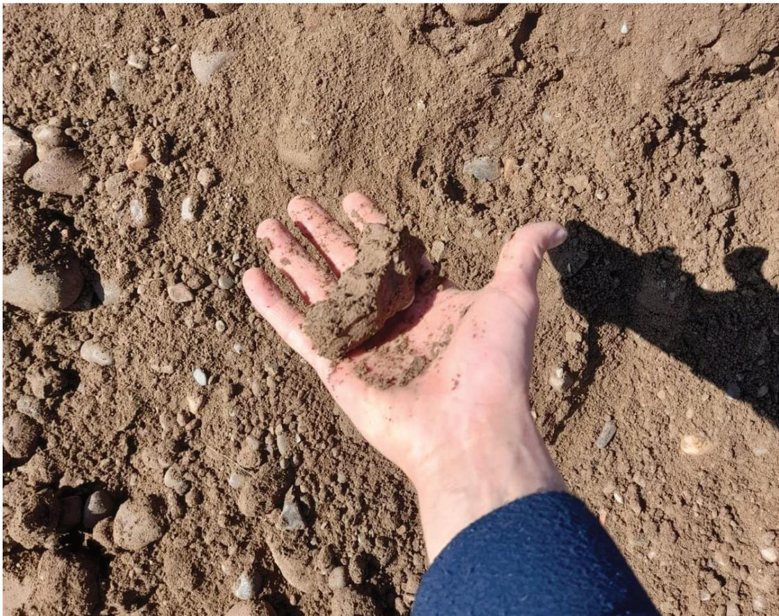
*Figura 36: Prueba cualitativa realizada en campo para control de humedad del material. Se observa una humedad cercana a la óptima dada por ensayo Proctor, manteniendo la muestra su forma al liberar la presión de la mano y no advirtiendo que la misma haya mojado la superficie de la piel. Además, no se observa el brillo característico superficial que indica un exceso de humedad presente entre los poros de los granos*
