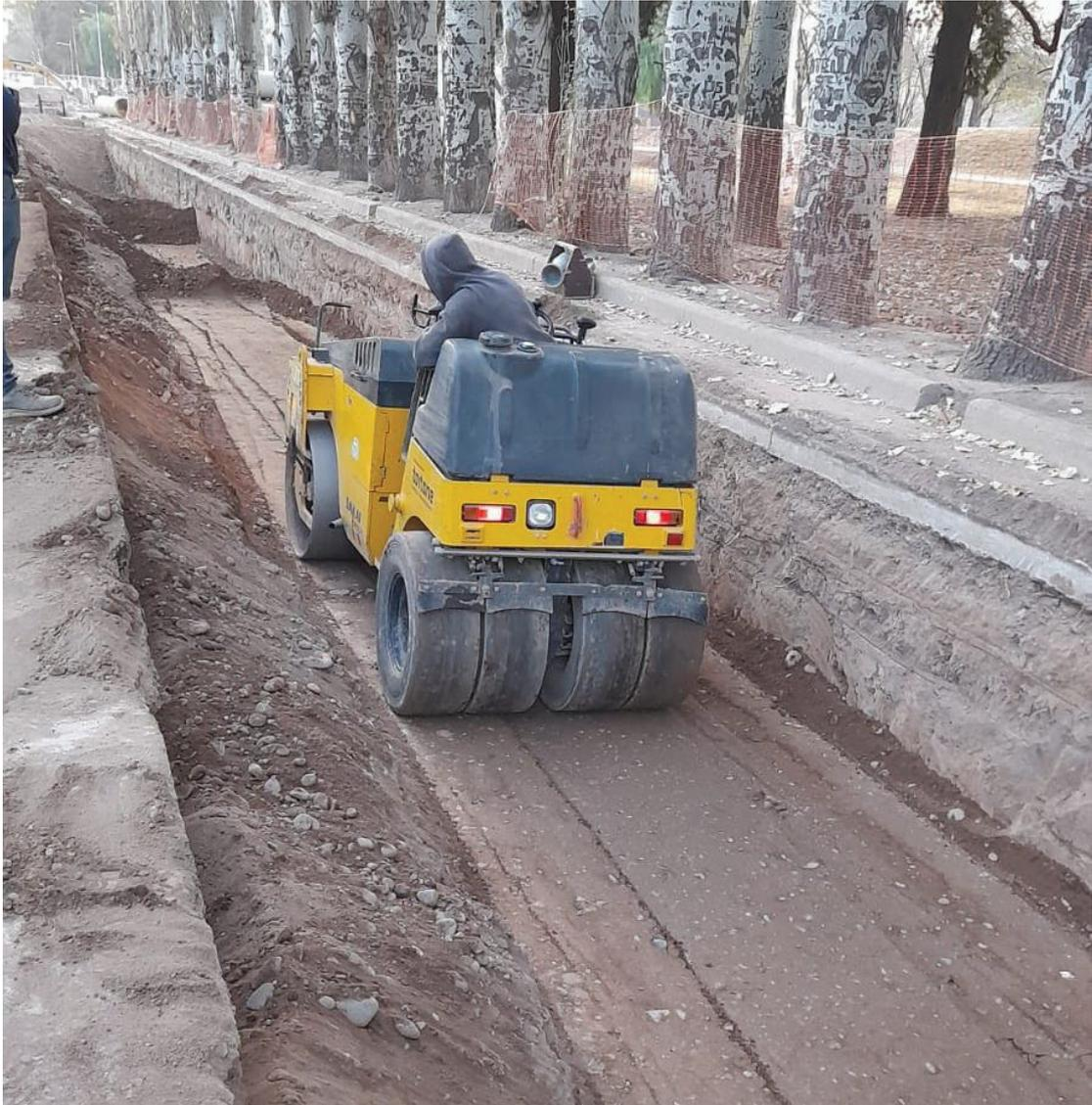
*Figura 42: Rodillo mixto: delantero liso, trasero neumático. Mejor en muchos aspectos que los rodillos lisos, ya que combina diversos mecanismos de compactación: amasado, presión y vibración. Es aplicable para el caso de limos y arenas limosas y arcillosas, adaptándose también a suelos granulares por ser vibratorio*
